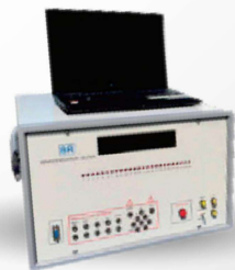
半导体分立器件 静态参数测试系统
