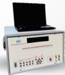
半导体分立器件 静态参数测试系统
